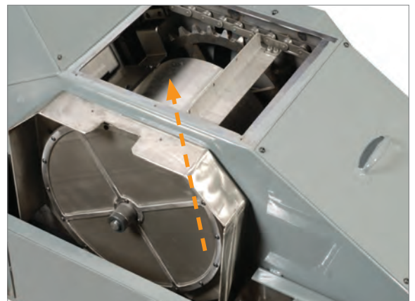
Tambour magnétique pour la séparation de copeaux de fonte fins
