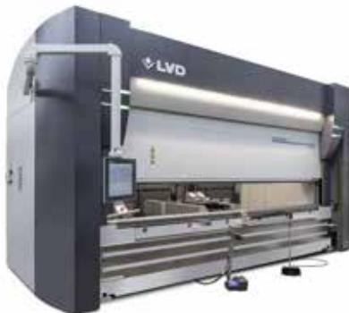
**Presse plieuse hydraulique complète avec changeur d'outils automatique intégré**
