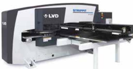
Poinçonneuse de grande capacité et haute performance, idéale pour la fabrication par lots
