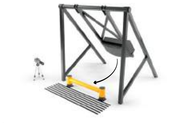
Fig.1 - Le bras du pendule est fixé à un angle de 90 degrés sur la protection contre les collisions.
