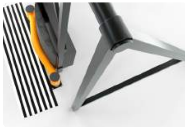
Fig.2 - Le bras du pendule avec son poids entre en collision avec la plaque d'immatriculation.
