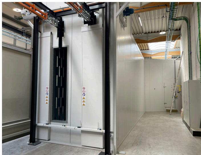
Les fours Coateq sont construits avec des panneaux en laine de roche à haute efficacité qui, grâce notamment à une conception sans ponts thermiques, forment un ensemble à l'isolation exceptionnelle.
