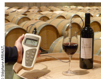
Prototypage fonctionnel d'une sonde électrochimique pour mesurer le dosage des sulfites dans le vin.
