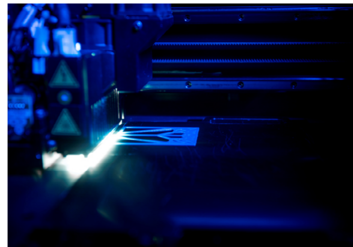
Impression multi-matériaux par projection de matière photopolymérisable.
