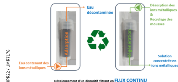
Développement d'un dispositif filtrant en flux continu.
