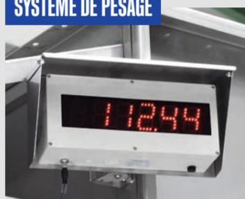
Un écran LED avec un affichage bien visible vous renseigne sur le poids rempli de l'installation. Comme pour le panneau web, l'affichage LED du système de pesage est protégé dans un capot de protection contre les intempéries en acier inoxydable et peut également être monté sur le BIG-Mix à un endroit convivial.
