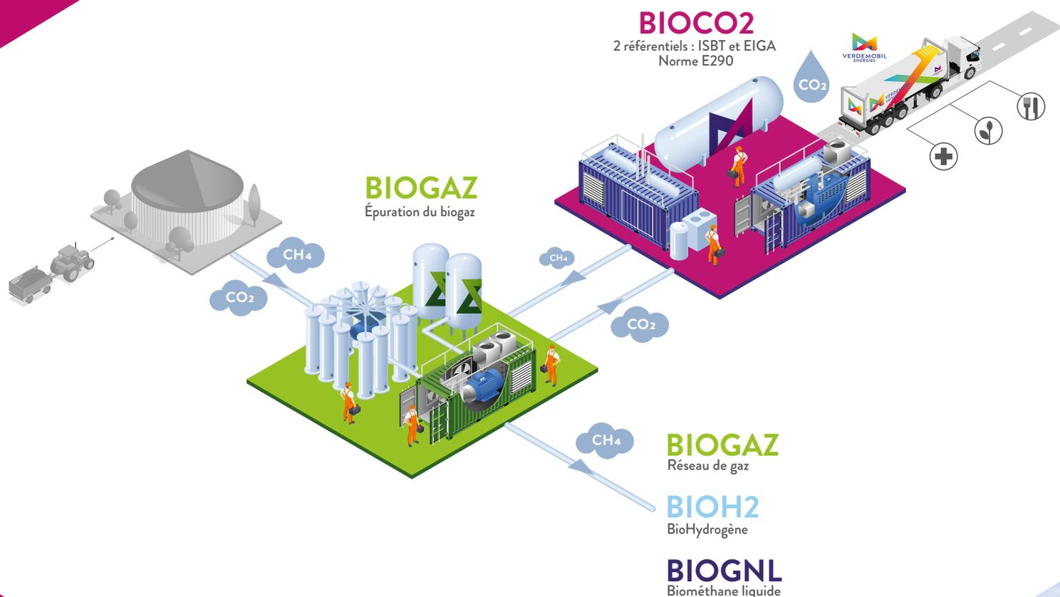
En couplant nos systèmes d'épuration du biogaz à notre système de captage et de valorisation du BioCO<sub>2</sub>, nous proposons une solution "zéro rejet" qui valorise 100% du biogaz, avec des coûts d'investissement et de fonctionnement très avantageux.
