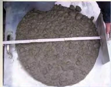
Contrôle de la consistance du béton UK2 à toutes les étapes du bétonnage avec éprouvettes
