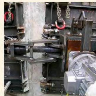
Dispositif de décoffrage électrique, breveté
