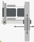
Adaptation optimisée à votre convoyeur grâce à un pied réglable en hauteur et en transversal
