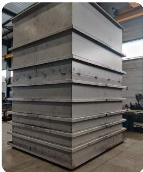
*Fabrication d'une cuve Inox 316L*
