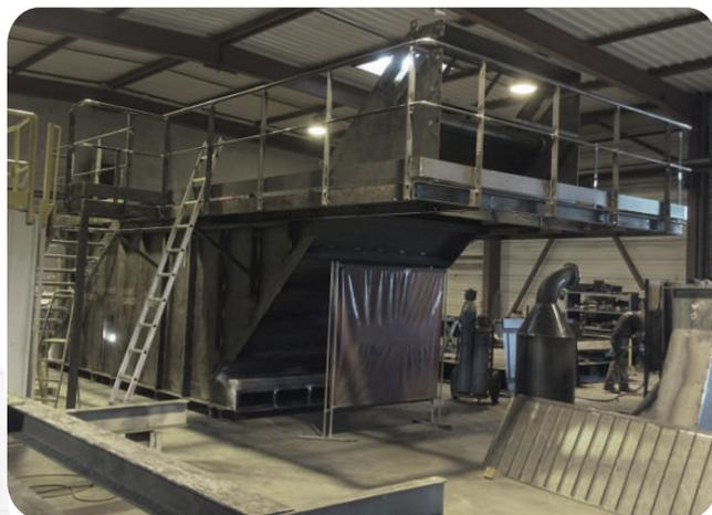
*Fabrication dans nos ateliers d'un filtre à dépression*
