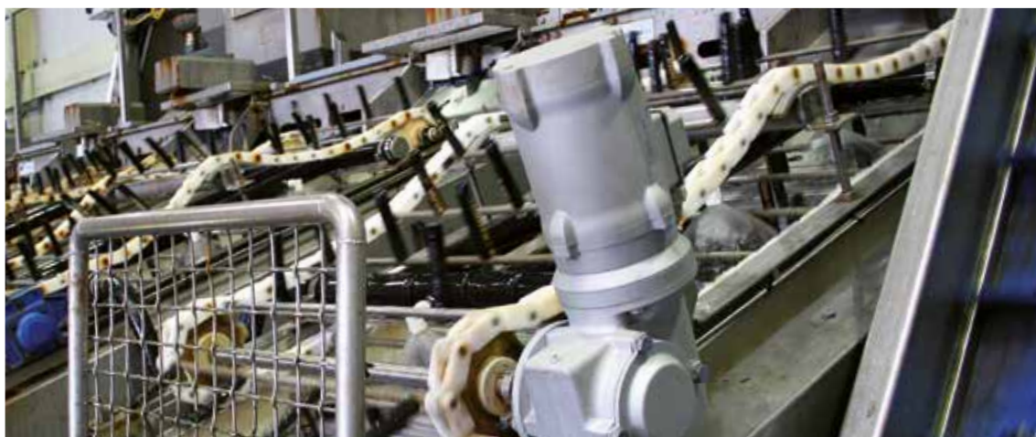
NORD moteur lisse avec nsd tupH
