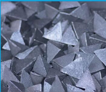
Le traitement est réalisé en cuve rotative. Les pièces sont brassées dans une charge de médias spécialement défini pour le type de matière.
