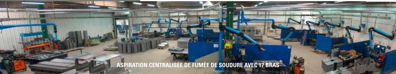
ASPIRATION CENTRALISÉE DE FUMÉE DE SOUDURE AVEC 17 BRAS
