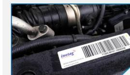
Étiquettes souples HF / UHF pour surfaces plastique résistant aux chocs thermiques 24h à -40°C puis 24h à +100°C et lavages haute pression 80°C, 50 bars
