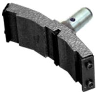
Il existe des **porte-pierres doubles ou triples** pour l'usinage de pièces ayant plus de 100 mm de diamètre.
