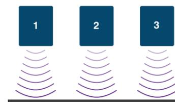
En mode synchronisé, les **capteurs à ultrasons** émettent leurs impulsions ultrasoniques simultanément. Cela permet de détecter un ou plusieurs objets sur une surface plus importante. Pour une même application, jusqu'à **40 capteurs** peuvent fonctionner simultanément en mode synchronisé.
