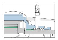
Etanchéité par presse-étoupe, avec ou sans bague lanterne, pour une utilisation de lubrification externe. Utilisée pour les hautes viscosités ou un certain niveau de fuite est accepté.
