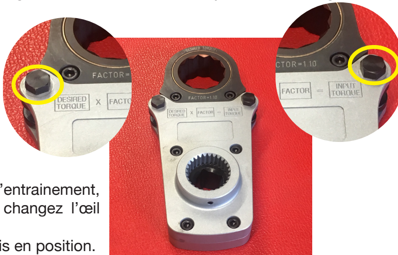
Bras de réaction engagé à droite => Système en serrage
