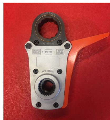
Bras de réaction engagé à droite => Système en serrage
