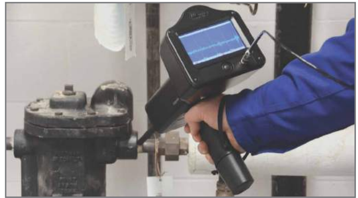
Ultraprobe 15.000. Detection de fuite internes
