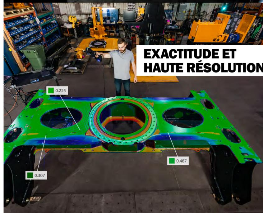
Grâce au référencement dynamique et à l'optimisation de l'exactitude volumétrique, cette solution de mesure 3D est conçue pour fonctionner dans des environnements difficiles et offrir une grande précision pour les mesures de grande taille, quel que soit le niveau d'expérience de l'utilisateur.
