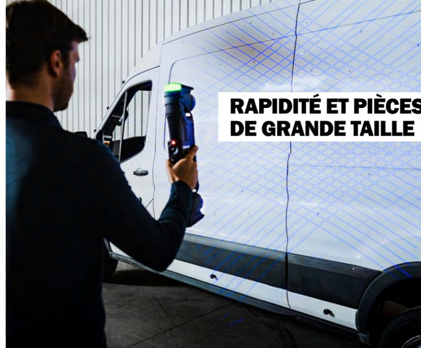
Grâce à ses 38 lignes laser et à sa grande zone de numérisation, la série HandySCAN 3D|MAX s'impose comme le scanner 3D idéal pour mesurer rapidement et facilement des pièces de grande taille, jusqu'à 15 m, et obtenir des résultats de qualité métrologique en quelques minutes seulement.
