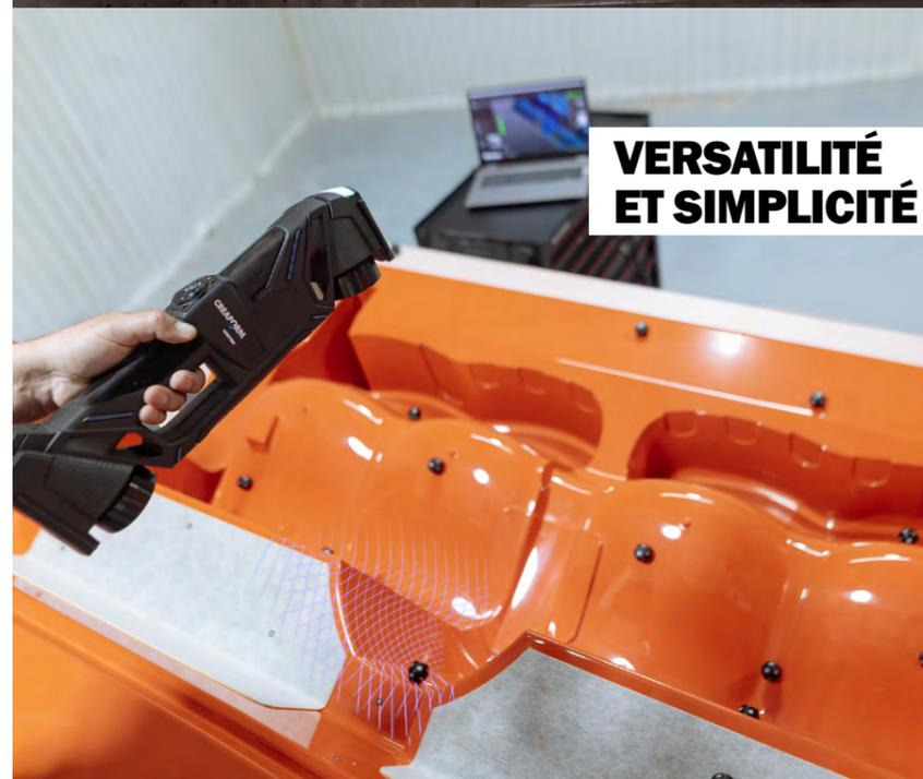
La série HandySCAN 3D|MAX peut maîtriser n'importe quel type de surface, y compris les surfaces brillantes, huileuses et même réfléchissantes, et ce, sans qu'il soit nécessaire de traiter la surface ou de préparer la pièce.
