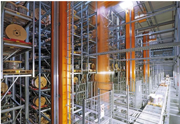
Stock automatisé à haut rayonnage
