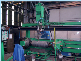
Rechargement Soudé - Banc de rechargement
