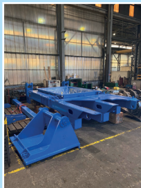
Fabrication châssis mécano soudé
