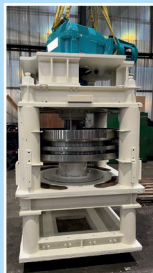
Remise en état pastilleuse à sel
