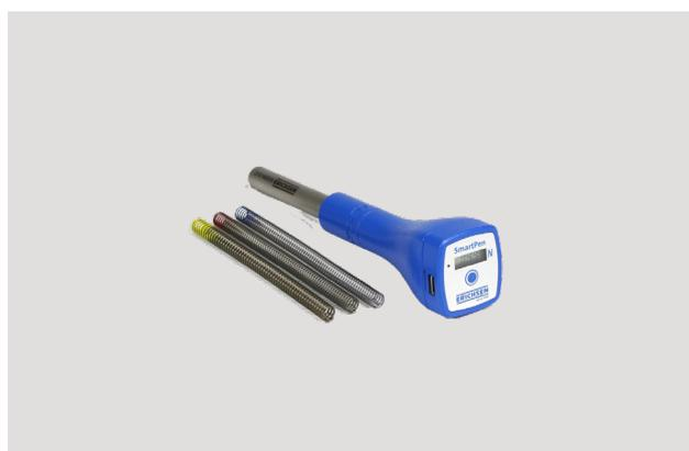
Crayon de dureté pour essai de résistance
