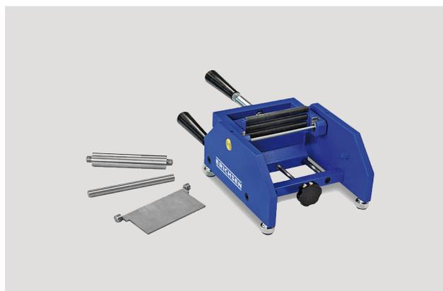
Appareil de pliage cylindrique ISO 1519
