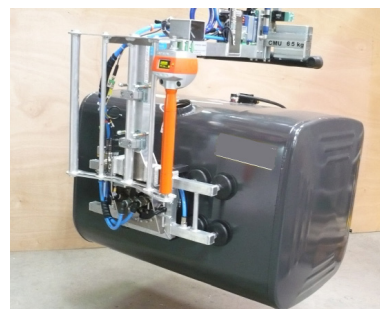
RÉSERVOIRS PAR VENTOUSES
