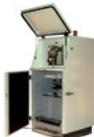
Conforme norme iso 5667-10, bac récepteur de 1 à 24 litres, isotherme ou réfrigéré
