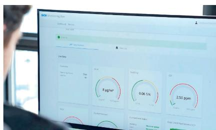
Nos solutions logicielles de monitoring incluent des tableaux de bords configurables, des alarmes, des envois de messages et d'alertes, des comparaisons entre machines, entre ateliers, entre usines et ce, sans limitation temporelle.
