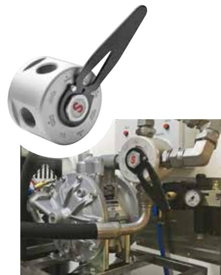
Les vannes à quatre voies simplifient l'installation du réseau de fluide et permettent l'utilisation d'une seule pompe pour vider ou remplir un réservoir de stockage, en modifiant simplement la position de la poignée.
