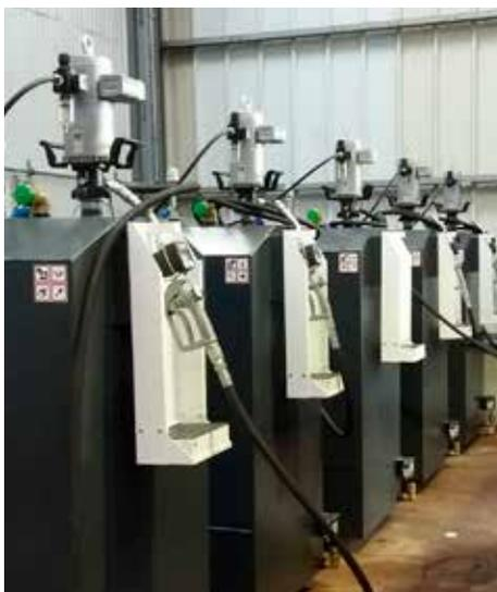
Pompes montées sur cuves
