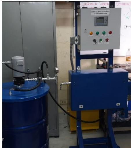
Graissage automatique avec un contrôleur
