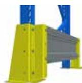
Un trafic intense sur les extrémités des rayonnages, voire dans les passages pont, occasionne souvent des dommages à l'installation. La protection d'extrémité stow est composée d'une lisse principale en profil sigma, boulonnée sur deux pieds. Des pieds intermédiaires sont rajoutés pour des longueurs plus importantes.
