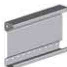
Les solives sont réalisées en profils sigma pour garantir une très grande résistance à la torsion sous charge. Une gamme complète de profils sigma en acier micro-alliage de haute qualité est disponible. Le type de plancher en bois ou caillebotis, la taille et la capacité de charge de la plateforme, sont les facteurs déterminants de la portée des solives et la distance entre elles.
