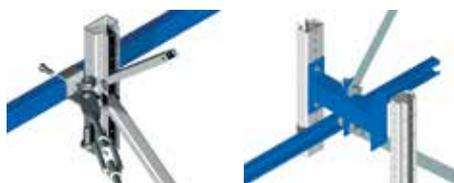
Les contreventements verticaux et horizontaux garantissent les tolérances de montage requises pour ce type d'installation (FEM 9 832).
