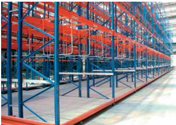
Accessoires spécifiques permettant un stockage vertical des marchandises. Les séparateurs sont réglables en hauteur et en largeur.
