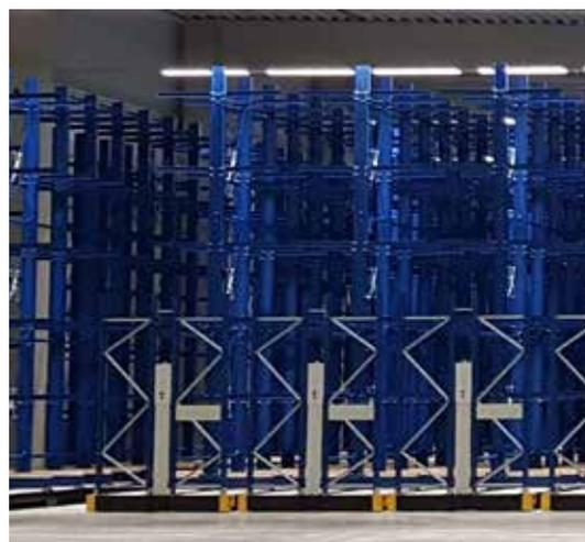
D'autres systèmes de stockage peuvent être installés sur les embases mobiles, comme p.ex. les rayonnages cantilever.
