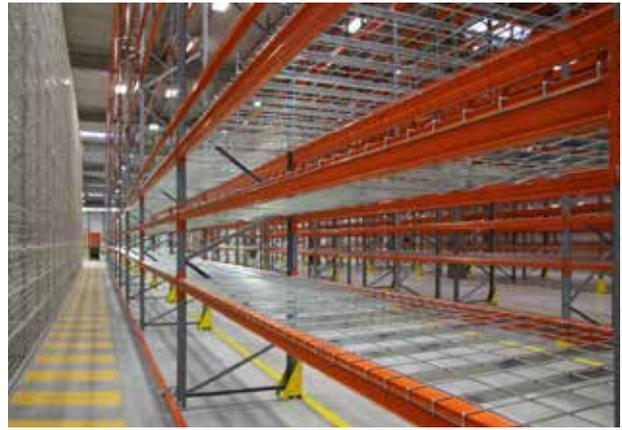
Palettier avec platelage panneaux fil. Le convoyeur est intégré dans le panneauage des échelles de rayonnage
