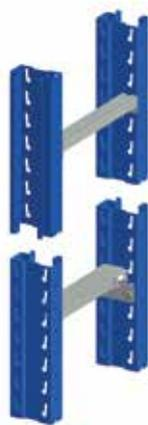
Des entretoises de jumelage sont placées dans les rangées doubles, reliant les deux échelles; elles peuvent également être utilisées pour fixer le système de protection incendie. Selon les besoins, des montants complémentaires peuvent être utilisés avec les échelles standards. Ces installation sont appelées «échelles 3 montants». le montant supplémentaire est raccordé à l'échelle par des entretoises spécifiques.
