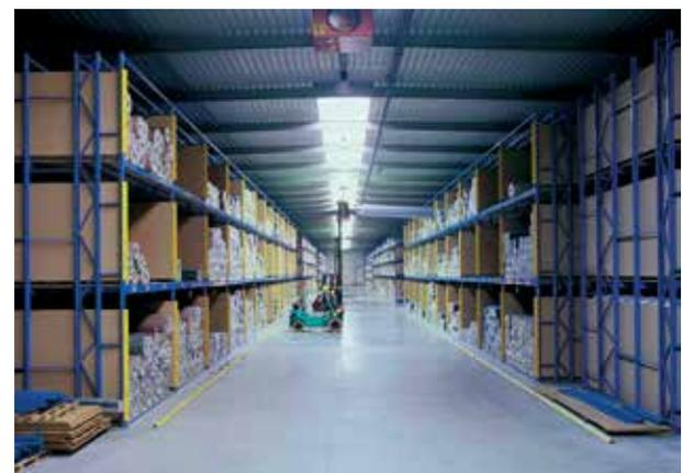
Rayonnages pour stockage horizontal de rouleaux tapis, équipé de panneaux latéraux et de protections toute hauteur.
