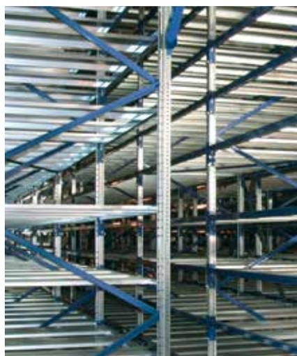
La construction repose sur le système de rayonnage à palettes stow.
