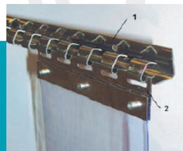
Chaque modèle de porte à lanières est composé d'un profil de fixation (1) en partie haute à accrocher au-dessus de votre ouverture ; et de lamelles de PVC souple transparentes (2) venant cloisonner l'ouverture.
