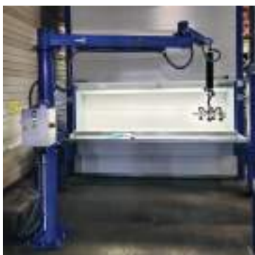
Manutention de cartons en sortie de tour de stockage
