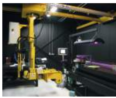
Colonne télescopique prise de pièces métalliques
