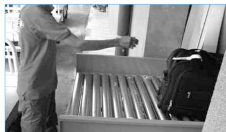
Convoyeur de dépose
