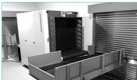
Machine de sûreté contrôle bagages au format en soute
