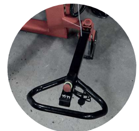
Le timon peut se placer sur le côté pour faciliter l'accès à l'opérateur
