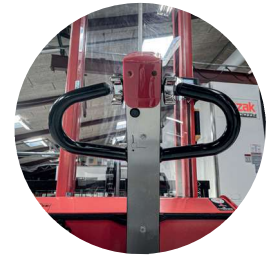
Timon ergonomique / avec arrêt d'urgence
