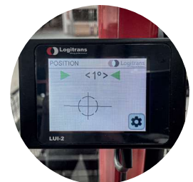
Paramétrage possible des angles et de la vitesse de rotation
