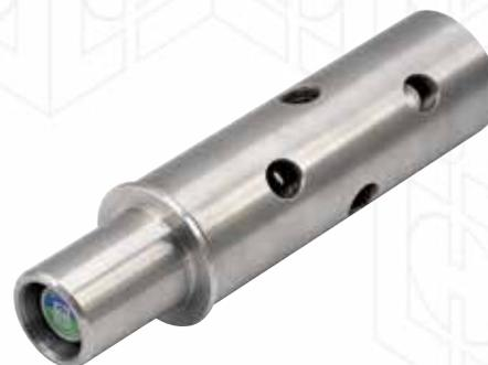
Les tourillons sont fabriqués sur mesure et sont conçus pour augmenter la résistance de l'arbre à la flexion et éviter le cisaillement des vis. Les portées internes sont usinées avec précision pour un ajustement coulissant.
