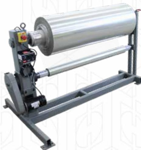
Le Safe-Slab se décline en plusieurs variétés selon les besoins du client. Il permet de dévider rapidement les fins de bobines afin de recycler la matière et de récupérer les mandrins pour de nouvelles utilisations.
