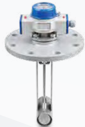
DW 184 Contrôleur de débit de type à insertion pour un diamètre de tuyauterie \geq DN250 / NPS 10, raccordement process DN150 (EN) / NPS 6 (ASME)
