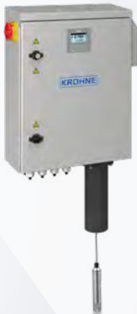
OPTPTISYS SLM 2100 Système de mesure optique du voile de boues conçu pour la mesure du profil de sédimen- tation et le suivi continu du voile de boues
