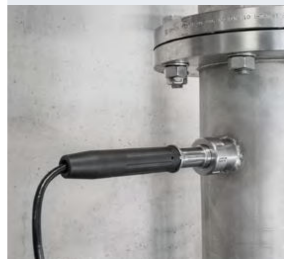
Mesure du pH dans une laiterie avec système à insertion
