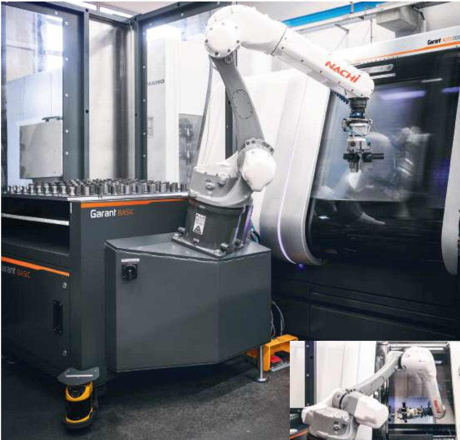
Système de chargement GARANT Automation Basic utilisé avec GARANT Auto Door : système simple d'utilisation et sûr, ici pour le tournage de petites séries.
