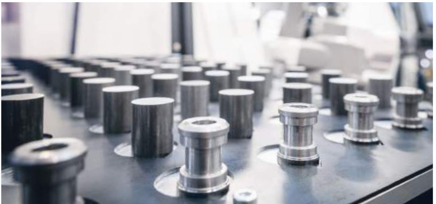
Une plaque crantée définie facilite la préhension et la dépose des composants par le bras du robot.
