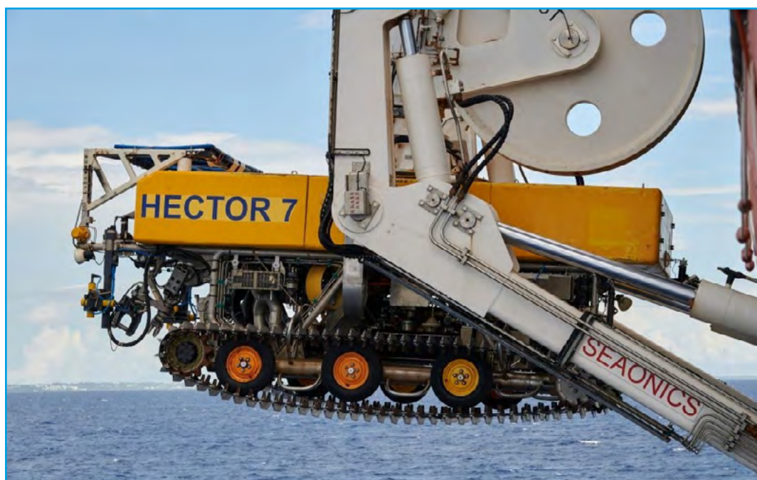
▲ Figure 3 : Exemple d'engin de fond : le work class ROV HECTOR 7 opéré par Orange Marine. Source : L. MIQUEL, Armateurs de France. 15
