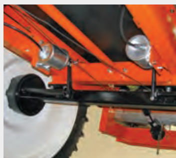
Freins pneumatiques (Homologation européenne 167/2013)
