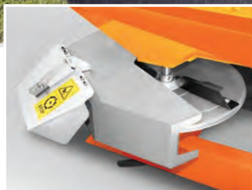
Convoyeur bilatéral en inox avec démontage rapide
