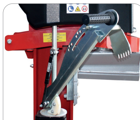
Griffe de maintien du bois ajustable et ergonomique, avec vérin à gaz
