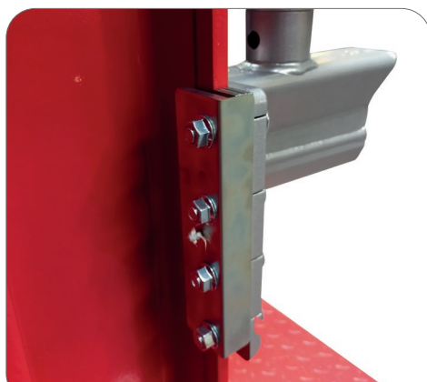
Glissières en laiton avec graisseurs
