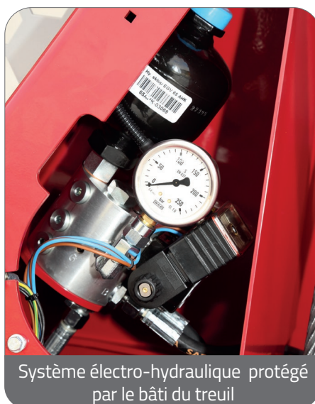
Pompe + multiplicateur à engrenage. Un filtre pression assure la pureté de l'huile
