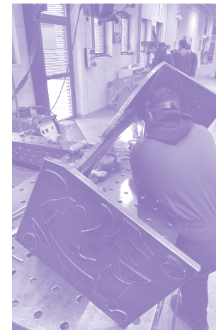
ATELIER #7 Soudure des éléments venant solidifier le banc. Les apprenti-es gravent leur nom sur le tableau métallique.
