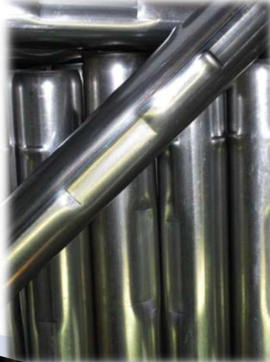
**5<sup>ème</sup> niveau** : Assemblage des différents composants pour obtenir les tarages en détente et compression. Puis remplissage d'oléofluide, sertissage, derniers tests et essais de conformité.
