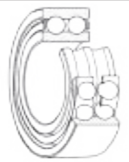
Roulement à billes à contact oblique 2 rangées Double row angular contact ball bearing
