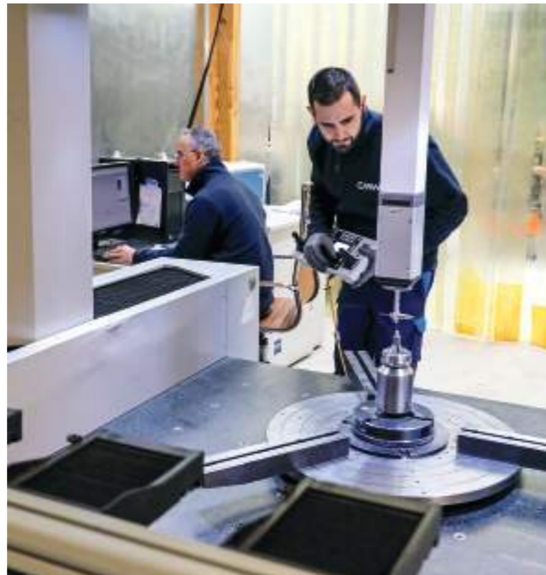
CMW - Contrôle « Zeiss » tridimensionnel ou de la denture Three-dimensional "Zeiss" inspection or gear tooth inspection
