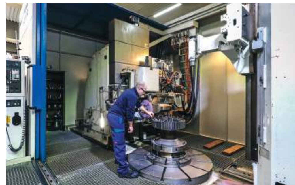
CMW - Taillage des engrenages jusqu'au diamètre 2,50 mètres Gear cutting up to a diameter of 2.50 meters
