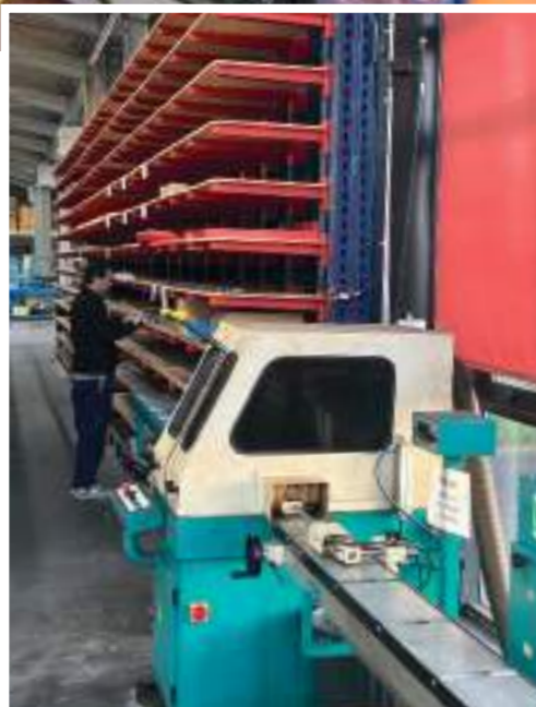
ITAFRAN - Découpe et mise à longueur des rails de guidage linéaire Cutting and sizing of linear guide rails
