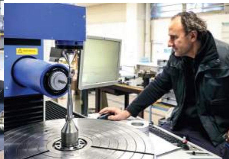
CMW - Contrôle « Klingenberg » de la denture, au micron près "Klingenberg" gear tooth inspection, accurate to the micron
