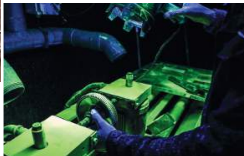
CMW - Contrôle de magnétoscopie Magnetic particle inspection
