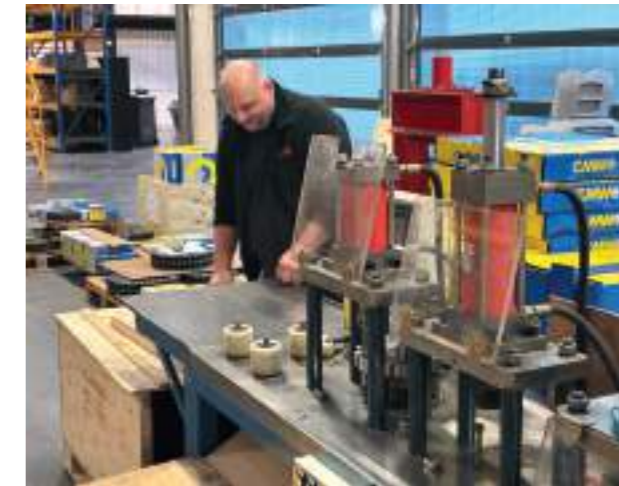
ITAFRAN - Découpe et rivetage automatiques des chaînes Automatic chain cutting and riveting process
