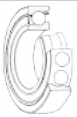
Roulement à billes à contact oblique 1 rangée Single row angular contact ball bearing
