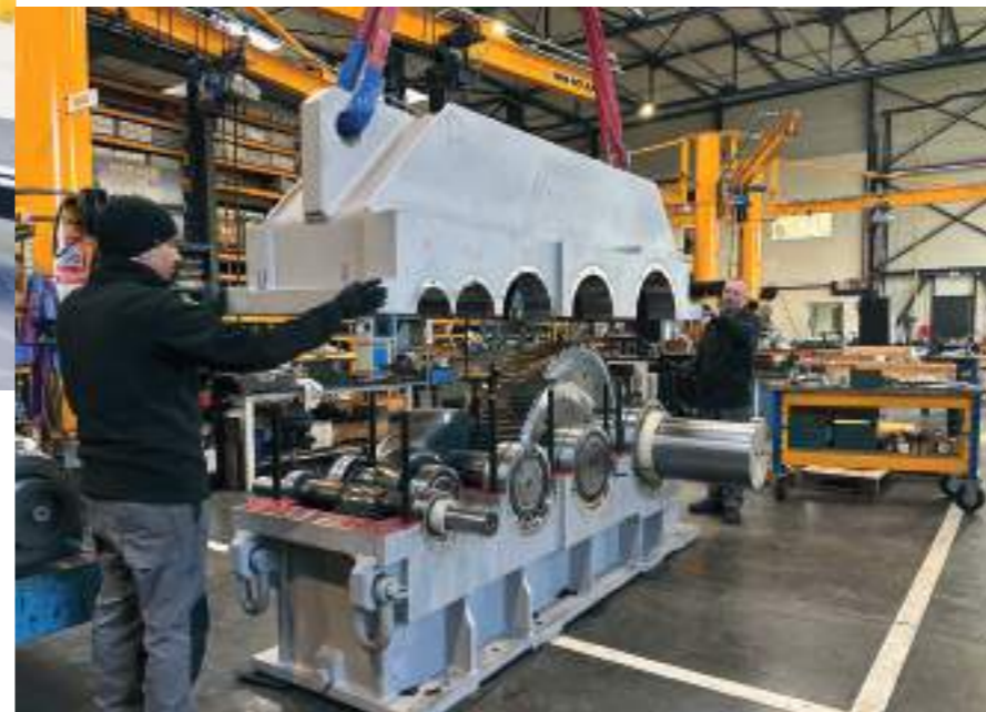
MERGER - Réducteur pour les broyeurs et concasseurs, ou la mise en mouvement des tapis roulants (mines et carrières) Gear reducer for crushers and grinders, or for driving conveyor belts (mines and quarries)
