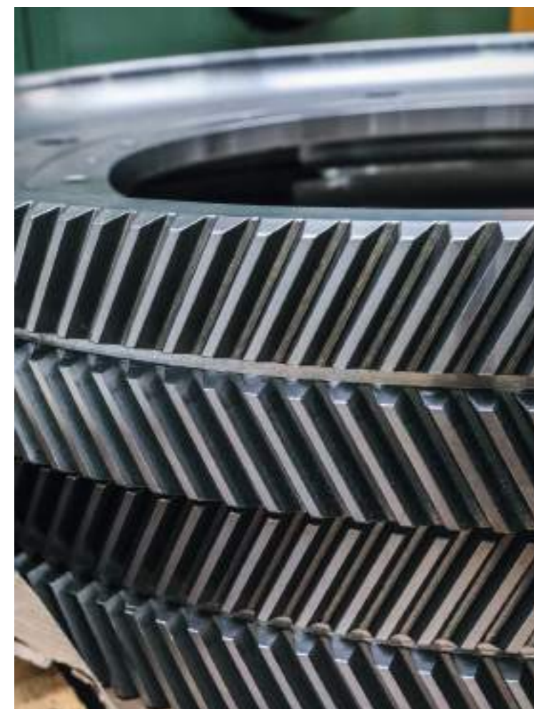
CMW - Taillage de la fameuse denture « chevron » Cutting of the famous "herringbone" gear teeth
