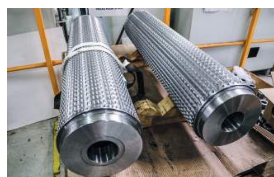
CMW - Rouleaux pour la suppression des écorces (industrie du bois) Rollers for bark removal (wood industry)
