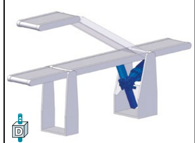
Réglage en hauteur d'une bande transporteuse
