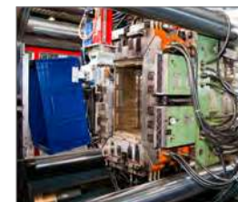
Production en série via un moulage par injection
