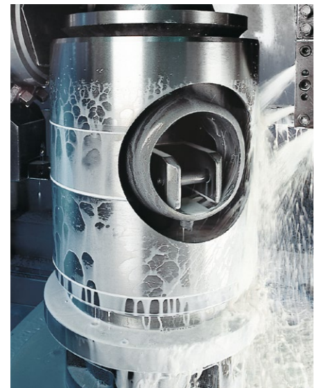
Fabrication de pistons gros calibre avec BECHEM Avantin
