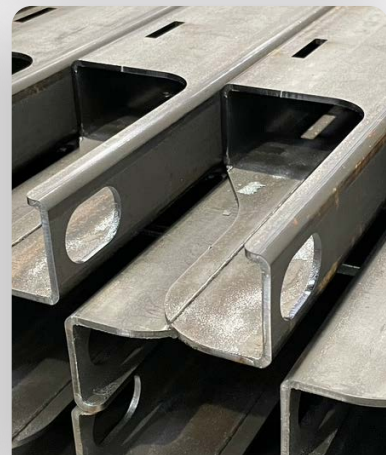
Découpe laser tube pour assemblage
