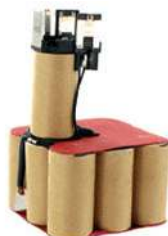
Fabrication et assemblage du nouveau Pack
