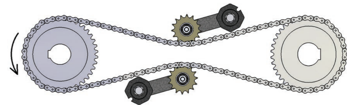
2 BRAS TENDEURS MONTÉS AVEC PIGNONS TENDEURS POUR UNE TRANSMISSION AVEC RÉVERSIBILITÉ DE MOUVEMENT.
