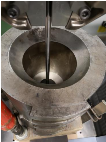
Exemple d'essai au poinçonnement d'une membrane d'étanchéité type EPDM – Exemple d'essai au cisaillement d'une planelle collée sur une brique en terre cuite
