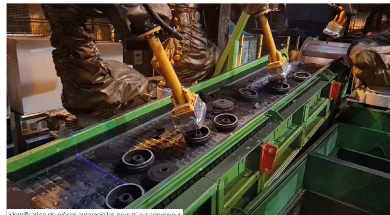
Identification de pièces automobiles pour tri sur convoyeur
