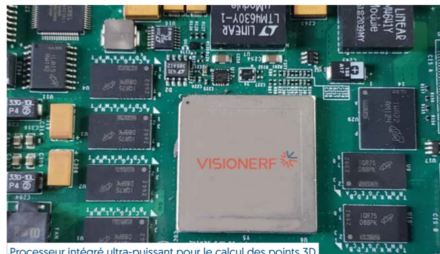
Processeur intégré ultra-puissant pour le calcul des points 3D
