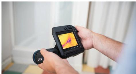
**Thermographie infra-rouge** afin de détecter les ponts thermiques constructifs et ceux générés par une infiltration
