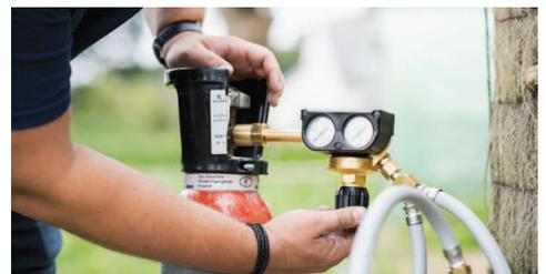
**Injection de gaz traceur** sous le complexe d'étanchéité (selon le mode constructif)
